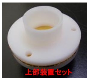
図 3-3-1 使用した簡易透過試験装置および組立て方法
