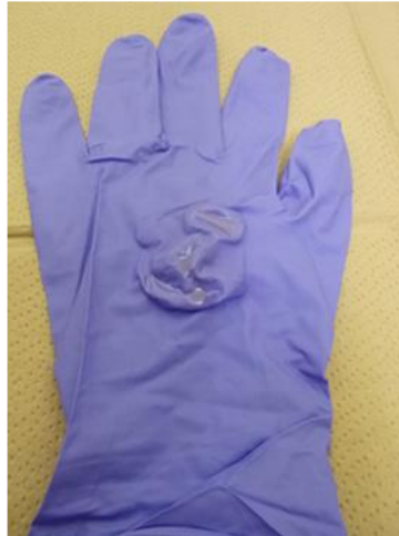
図 2-3 ニトリル手袋にオルトトリイジンを付着させたときの外観
