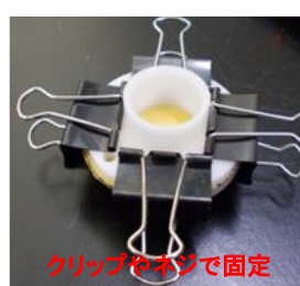
図 3-3-1 使用した簡易透過試験装置および組立て方法
