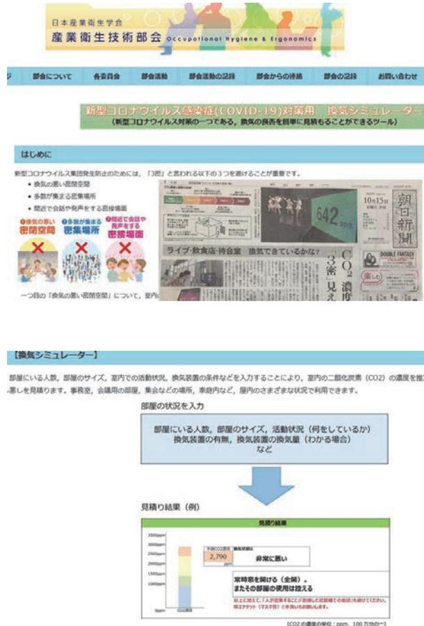
2020 年 2-7 月に国内で発生した COVID-19 クラスタ室内空間について、その室の形状やおおよその建築構造物、在室者数、使用 (在室者呼気活動) 状況、使用 (在室者同室滞在) 時間、その後判明した COVID-19 感染者数が報道で公開されたものについて、これらの変数を収集した。それをもとに、上記換気シミュレータを用いて、まず室内推計 CO2 濃度を算出した。なお、室内滞在時間によって生物学的曝露の量が異なることは自明であるから、単位時間 (1 時間) あたりの感染者数に変換し、単位時間あたりの感染者数 (時間感染率) と室内推計 CO2 濃度の関係を分析した。
