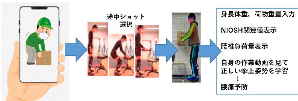
図4 労災(腰痛) 予防見える化アプリ スマートフォン撮影動画から重量物運搬業務（介護を含む）における労働負荷量を計算．国際標準NIOSH lifting equation ならびに腰痛誘発リスクとして腰椎負荷量を表示する予定である．労働者が自身の挙上姿勢を見て正しい挙上姿勢を学習する．
