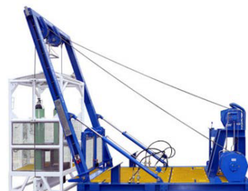
図-3. ダイバー昇降装置
