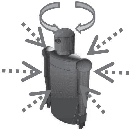
図5 均等被ばく状況を模擬する回転照射ジオメトリ(ROT geometry) [13] の模式図
