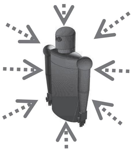
図6 均等被ばく状況を模擬する等方照射ジオメトリ(ISO geometry) [13] の模式図
