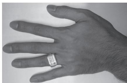
図 6. 千代田テクノル製 X・γ 線用ガラスリソング (JK型) 線量計②
