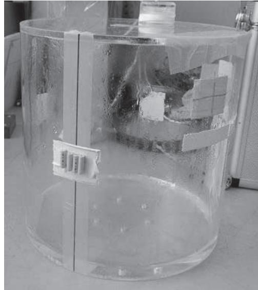
図 1 ガラス線量計 GD352M を ISO シリンダーファントムに設置した様子
