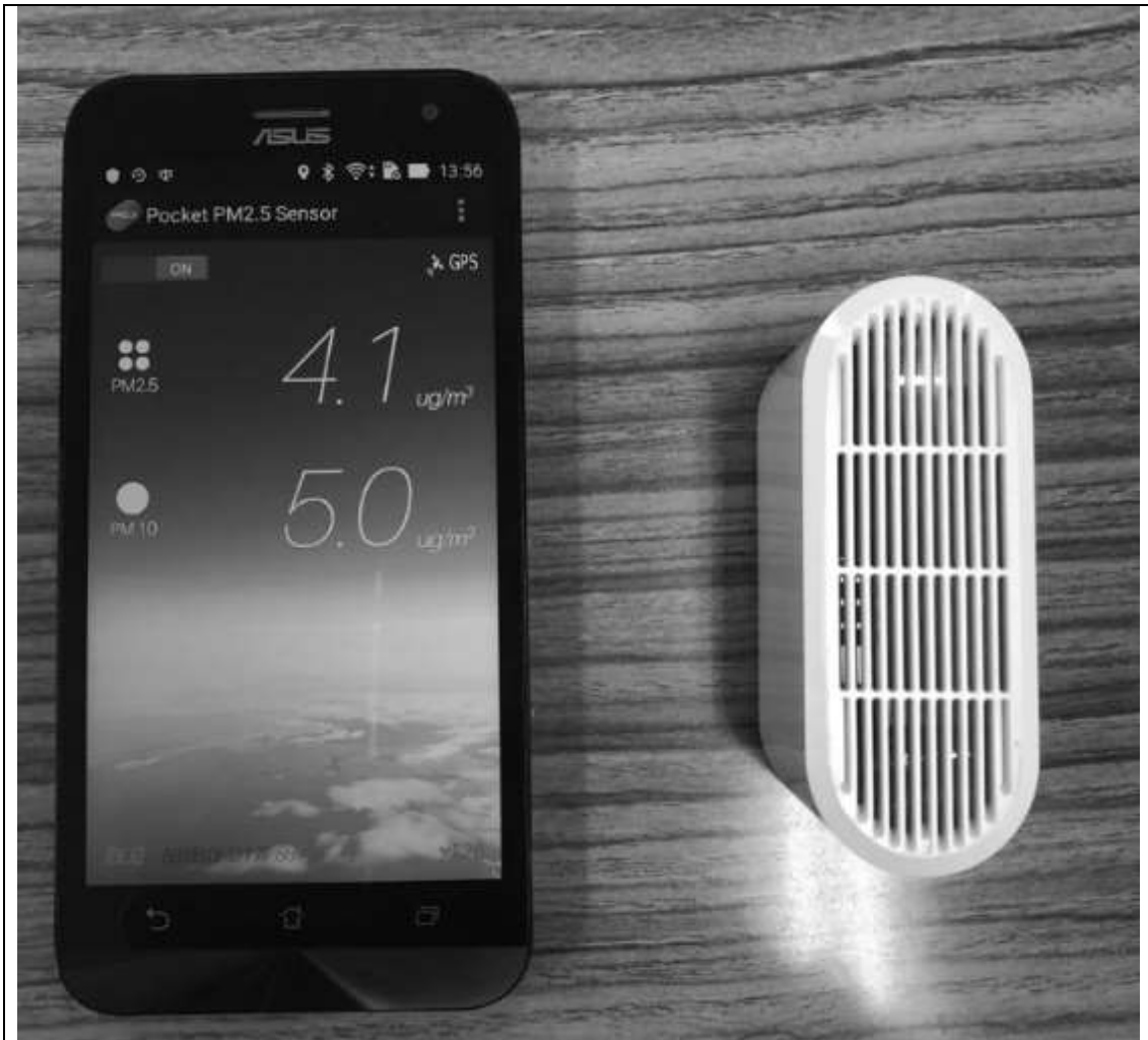
図 1. ウェアラブルパーティクルモニター(本体とアンドロイド用アプリケーション)
