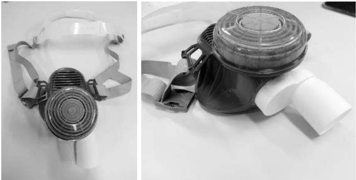
図3 通常防じんマスク用のアタッチメントを装着した状態の写真
