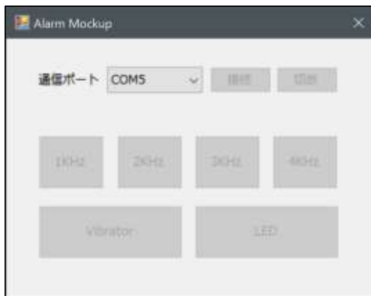
図3 アラーム機能の動作確認用プログラム(ラピッドプロトタイプ)
