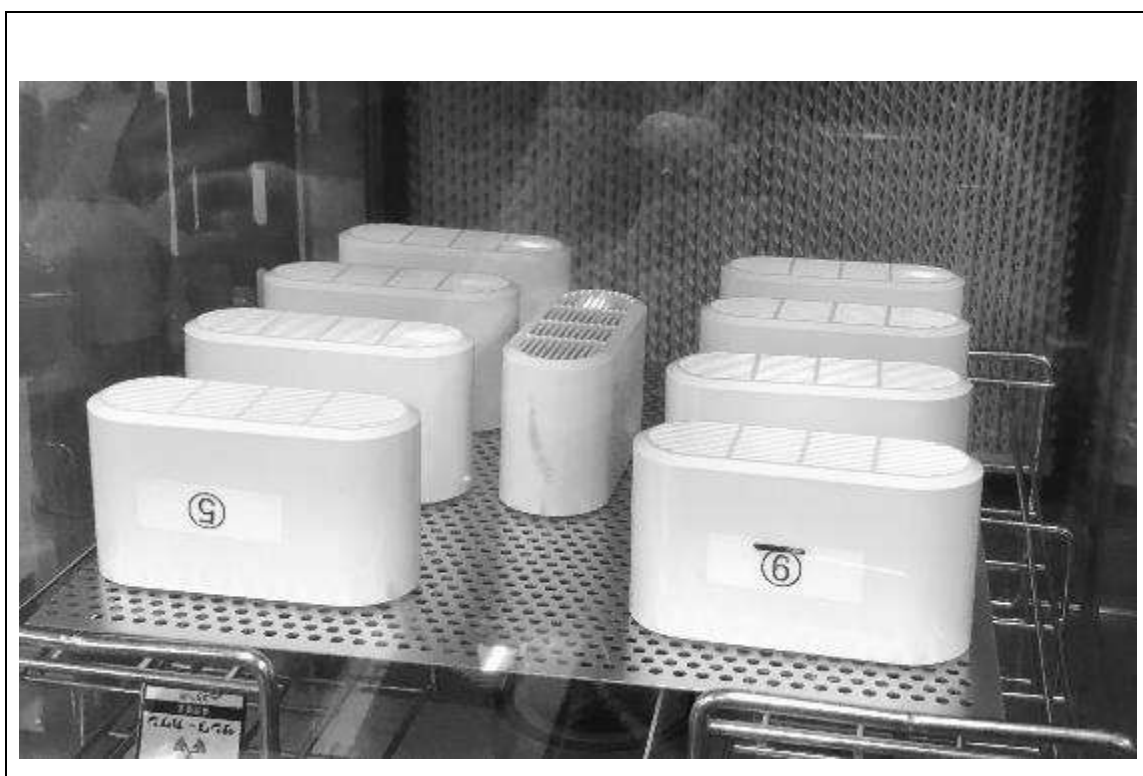
図3. ウェアラブルパーティクルモニターを設置した粉じんばく露チャンバー内
