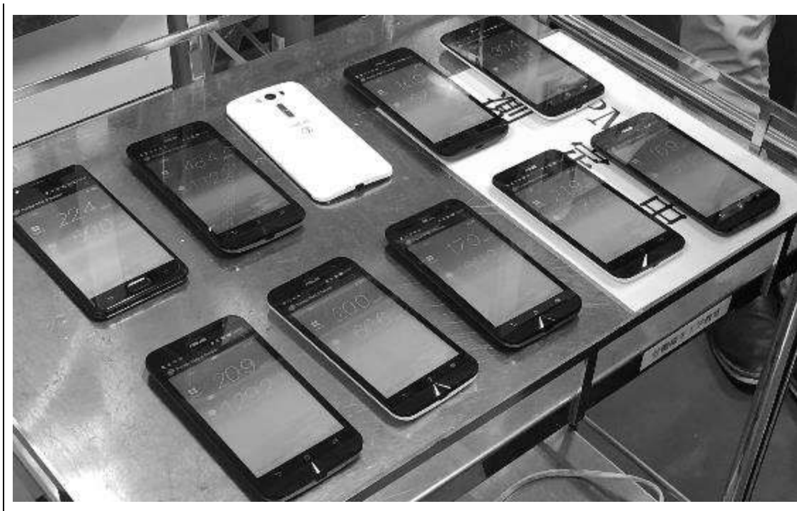
図 4. 粉じんばく露チャンバー内のウェアラブルパーティクルモニターによる粉じん濃度測定中の様子
