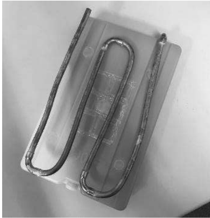
図2 試作段階の冷却部
