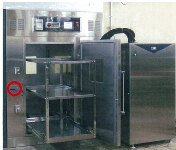
オゾンセンサー取付位置 : 床上約0.8m、扉の横
