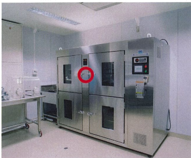
オゾンセンサー取付位置 : 床上約1m、扉の横
