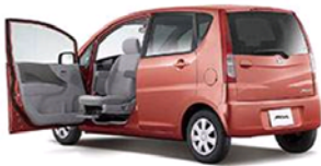
シートが外側に回転し、乗降が容易できる車
