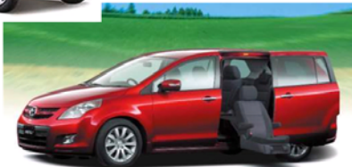
シートが外側に回転し、乗降が容易できる車
