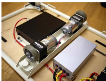
図3 第2次試作機の駆動部分
