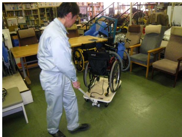
図 14 移動機後端の運搬用キャスター付き昇降部
