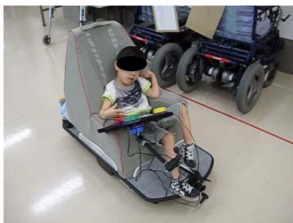
図2 姿勢保持装置に座り移動機に載せて自立移動
