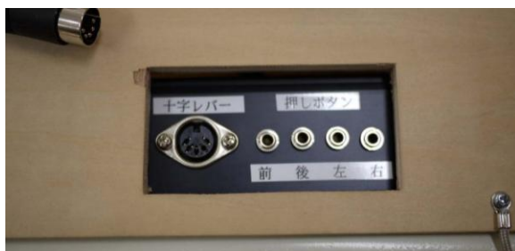
図 13 操作スイッチ接続用の 3.5mm ジャック
