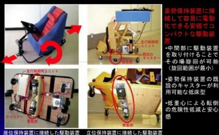
座位保持装置に接続した駆動装置 立位保持装置に接続した駆動装置
