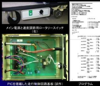
PICを搭載した走行制御回路基板(試作)
