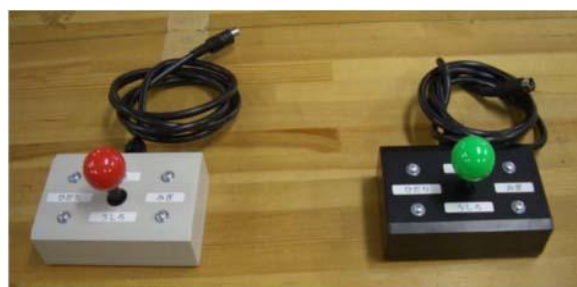
図 12 試作した操作スイッチ (十字レバー)
