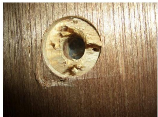
車輪取付け部破損状況
