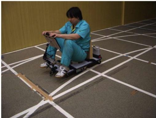
制動性能試験（制動距離） 傾斜角度 4^\circ 傾斜路面：319mm 平たん路面：101mm
