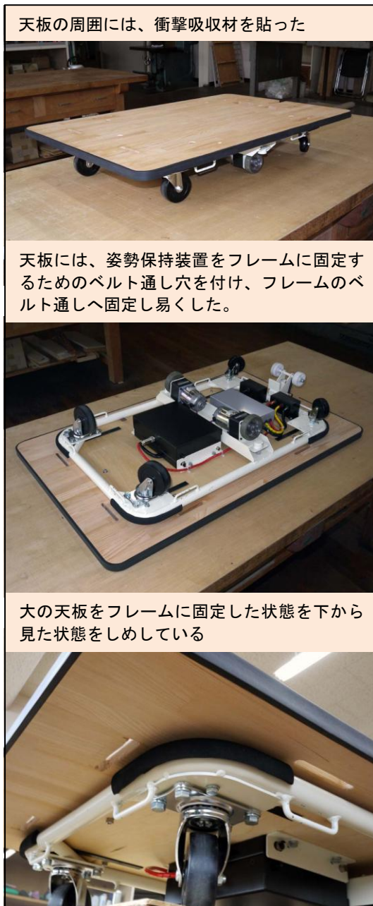
図 25 製作した天板を移動機に固定した状態
