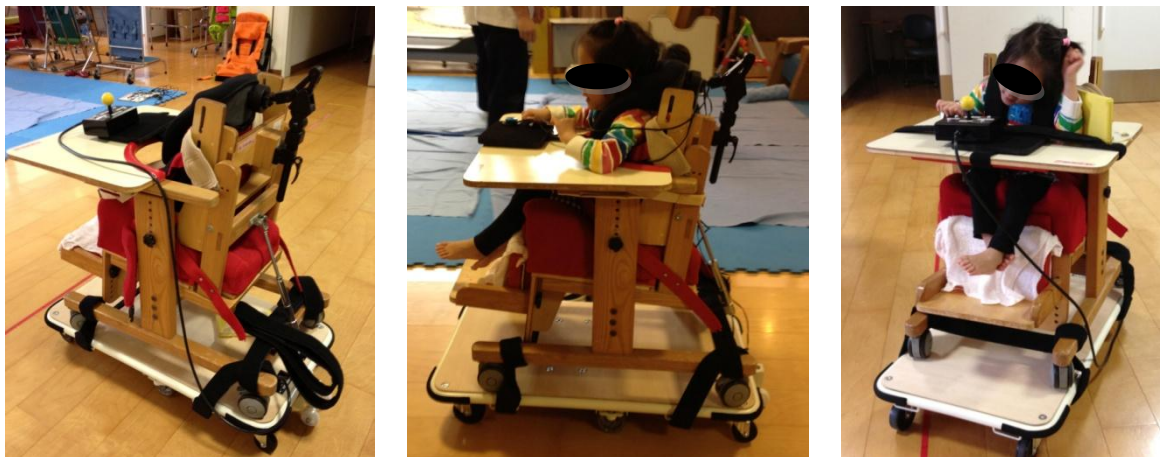
図31 本人が通常移動を介助してもらっている姿勢保持装置のまま乗せて自立移動している状況
