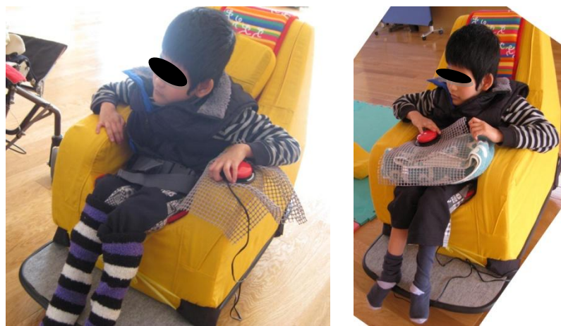
図 35 スイッチの場所を様々変更して、操作できる位置とスイッチの重さや大きさなどを検討して、スイッチを決める。
