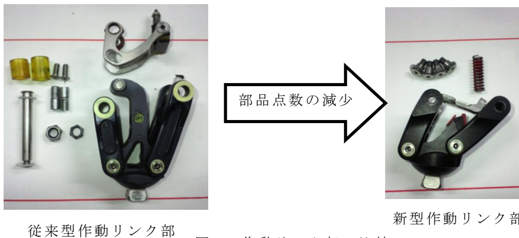
図 6 作動リンク部の比較
