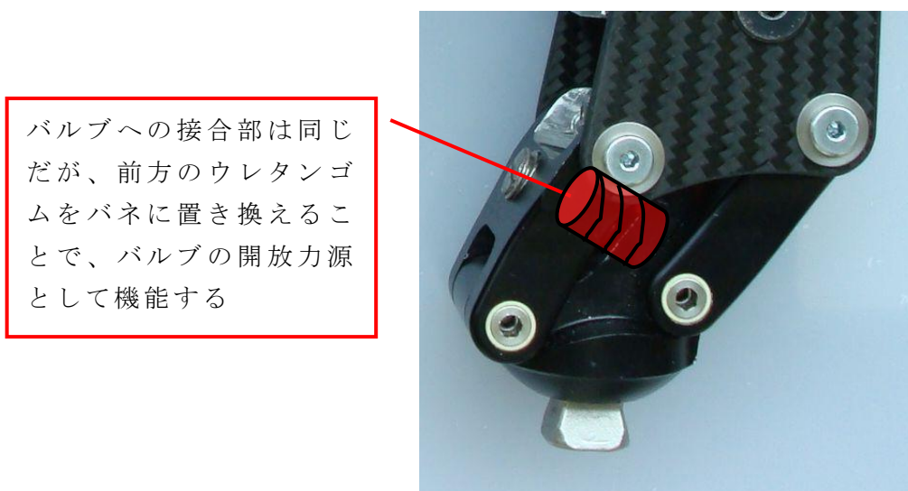
図12 4号機のバルブ接合部
