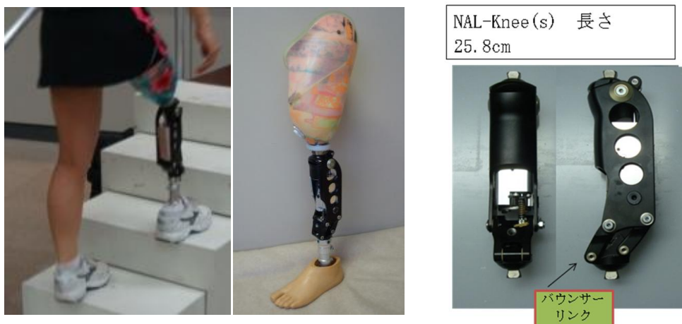
図 9 完成した膝継手 NAL-Knee(S)
