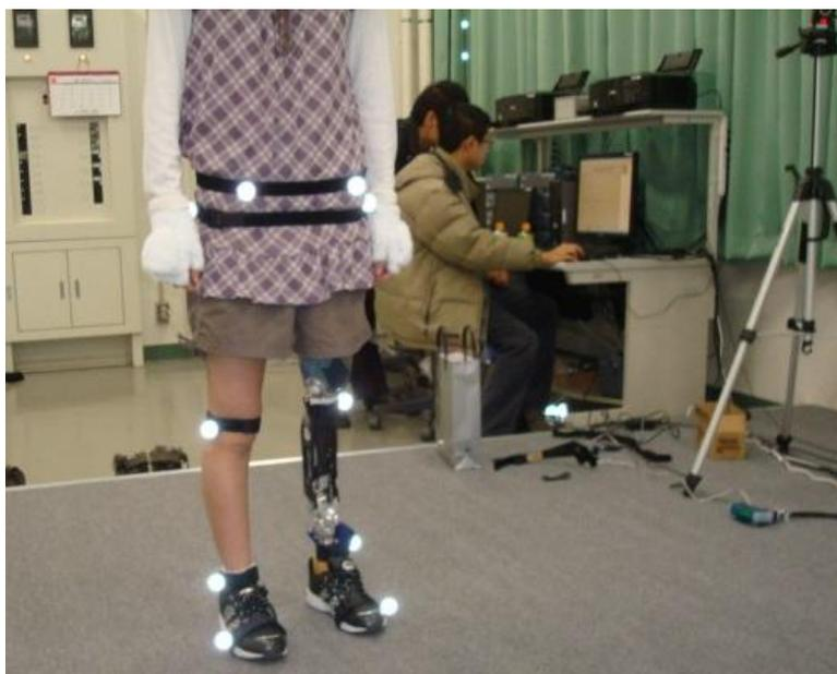
図3 マーカール取り付け箇所
