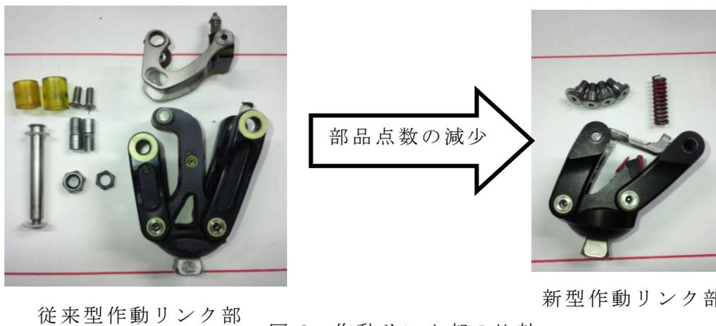
図 6 作動リンク部の比較
