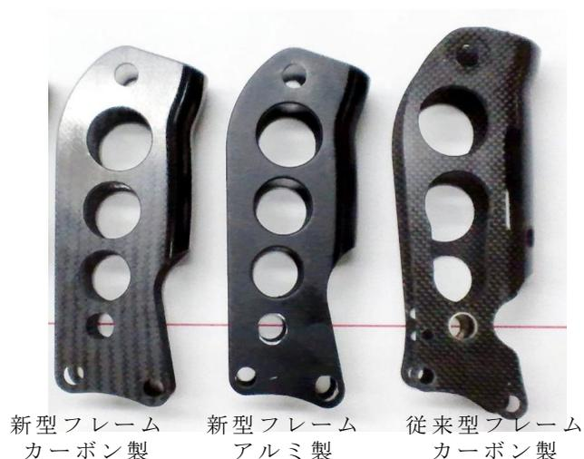
図 1 製作したフレーム
