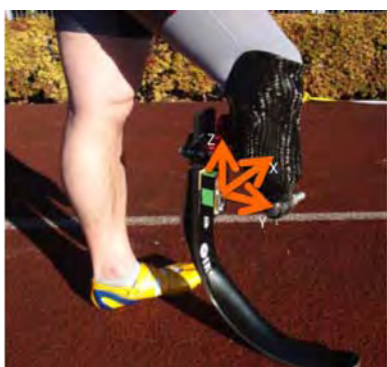
図 8 センサを装着した被験者の義足とセンサ座標系
