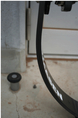
板バネ足部の層間剥離
