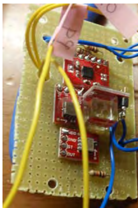
図 2 センサの基板への実装
