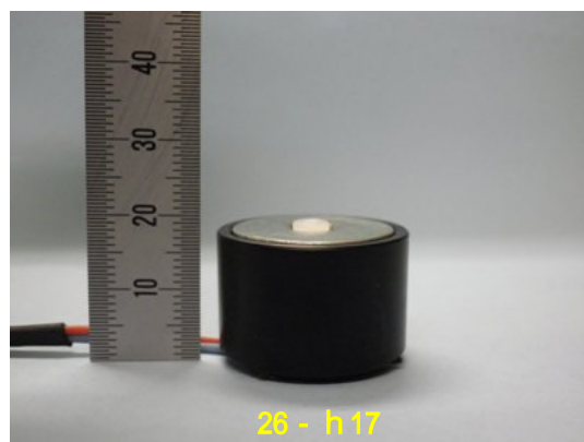
写真1 ソレノイド構造振動子
