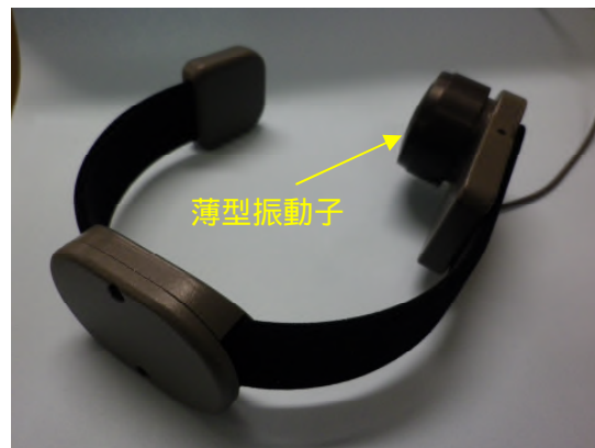
写真21 薄型振動子の取付状況
