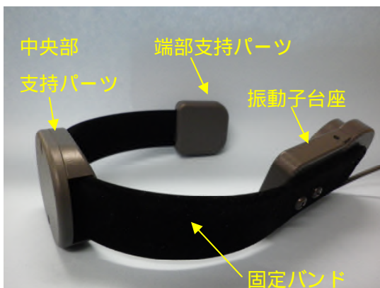
写真19 各パーツを取り付けた固定バンド
