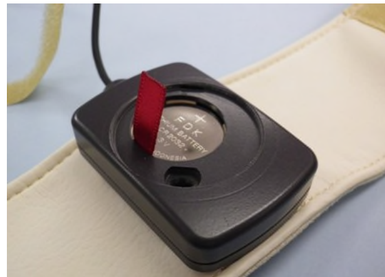
写真8 送信部 電池装着状態
