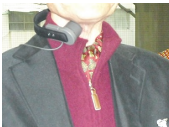
写真34 バネ弱—従来型振動子
