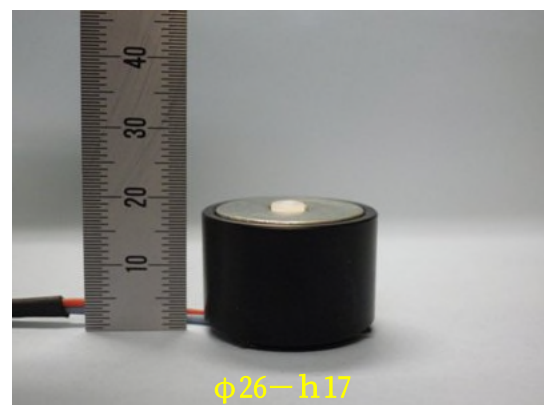
写真1 ソレノイド構造振動子
