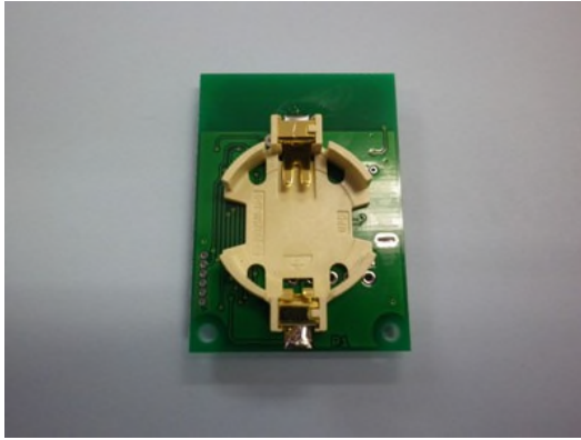
写真6 送信基板電池挿入部
