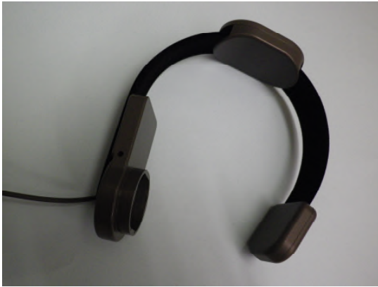
写真15 固定バンド取り付け状態
