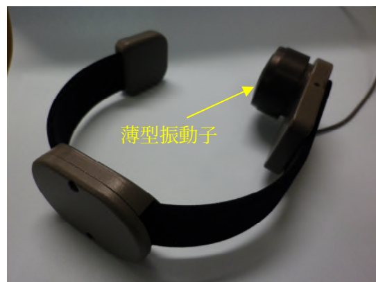
写真21 薄型振動子の取付状況
