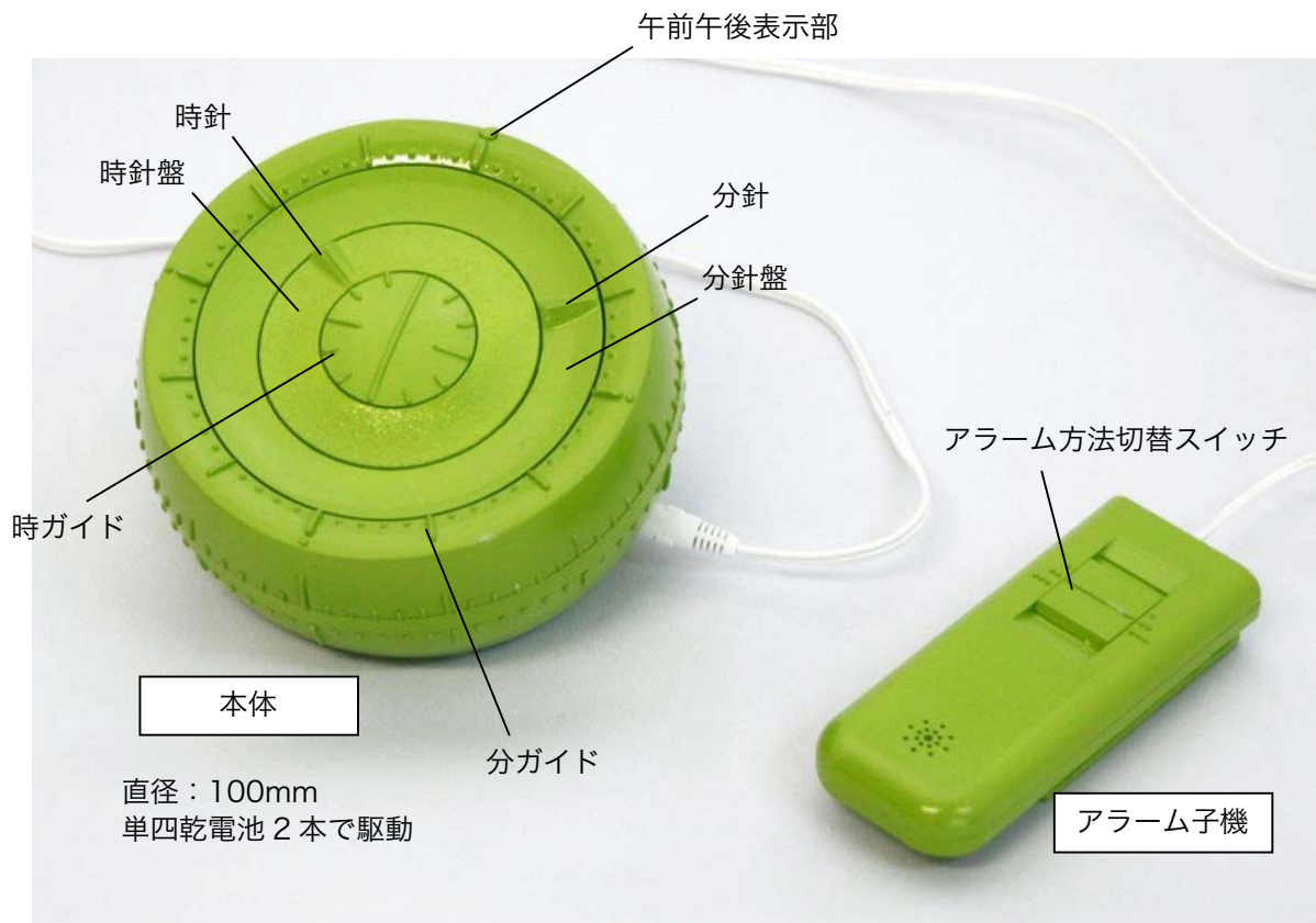
図 D-3. 試作機の構成（前面側） 写真は午後 10 時 10 分を表示した状態
