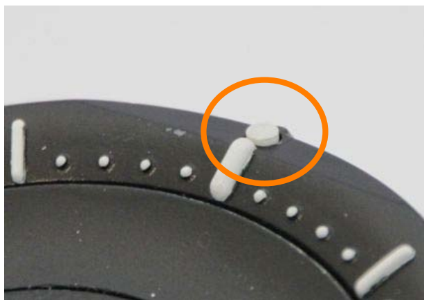
図 39. 午前午後表示部（写真は午後を表示）
