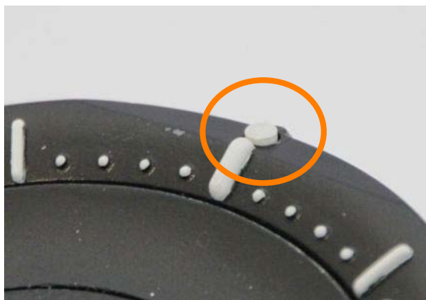
図 G-3. 午前午後表示部 (写真は午後を表示)
