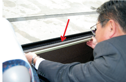
(B) 車載用 (モール内にループアンテナ内装)
