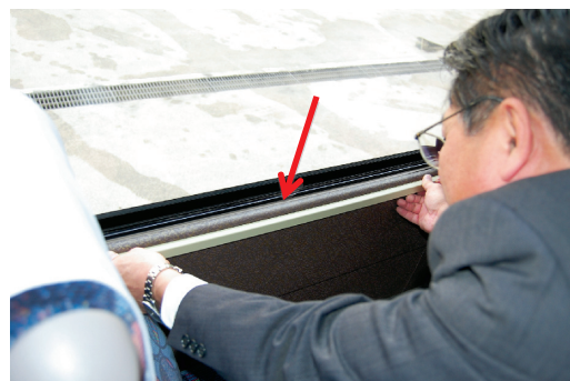
(B) 車載用 (モール内にループアンテナ内装)
