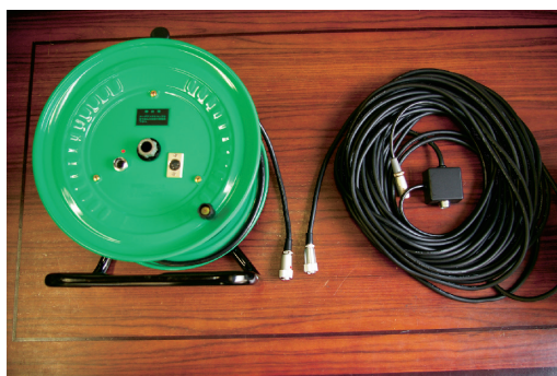
両磁気ループアンテナ (左側) 建造物用、(右側) 車載用
