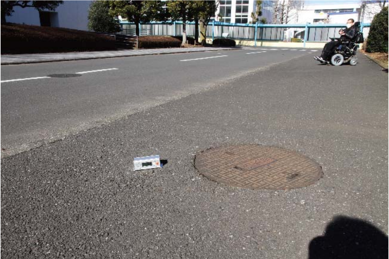
⑨ マンホールの乗り越え 路面からの盛り上がり部の傾斜 6.8^{\circ}
