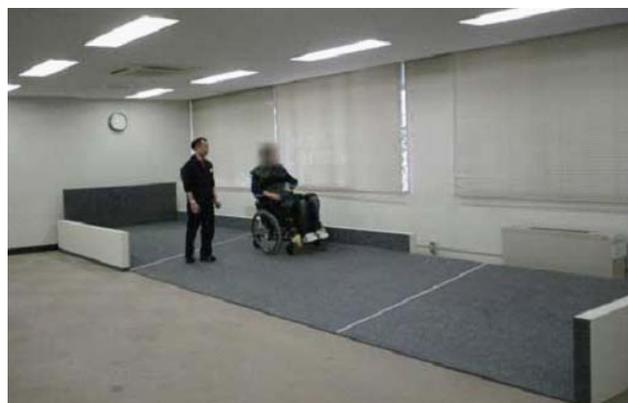
図3 傾斜地での直進走行試験の様子
