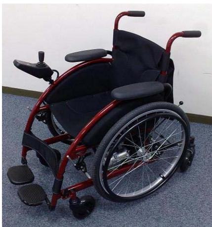
図2 安全で使い勝手のよい簡易型電動車いす外観
