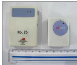
図2 頭に載せても気にならないサイズの脳波計
