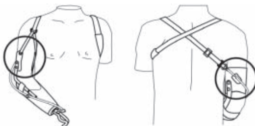
図-15 8 字ハーネス式と上腕カフの組み合わせ例（前腕義手用）
