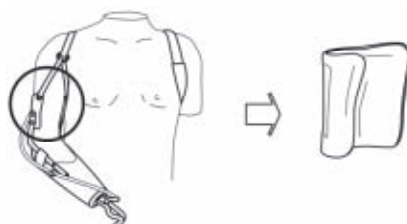
図- 20 肩義手用胸郭ベルトハーネス式と前腕義手用 9字ハーネス式の組合せ
