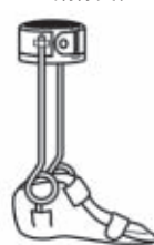
図－41 鋼線支柱の事例
