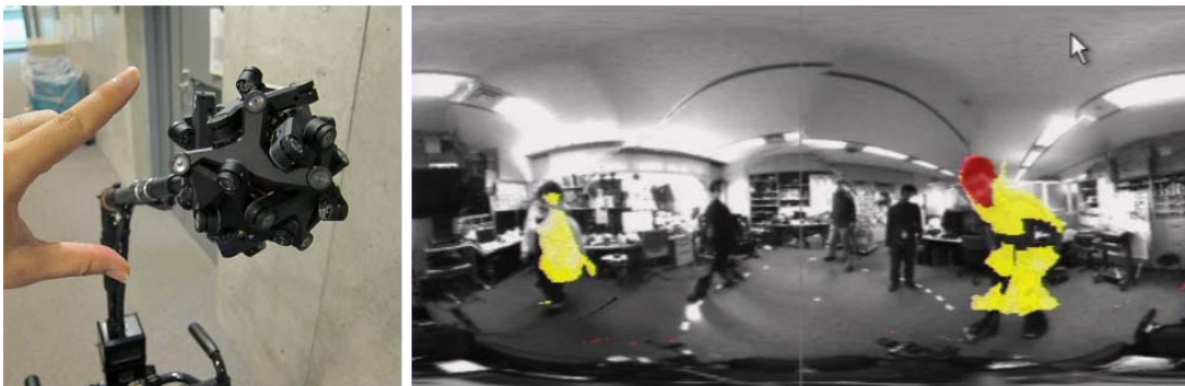
図4 左：赤外光照明対応全方向ステレオカメラ，右：衝突の危険がある歩行者の検出
