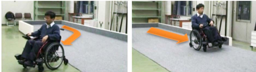
片流れ防止制御なし → 片流れ防止制御あり 図3 傾斜路における片流れ防止制御
