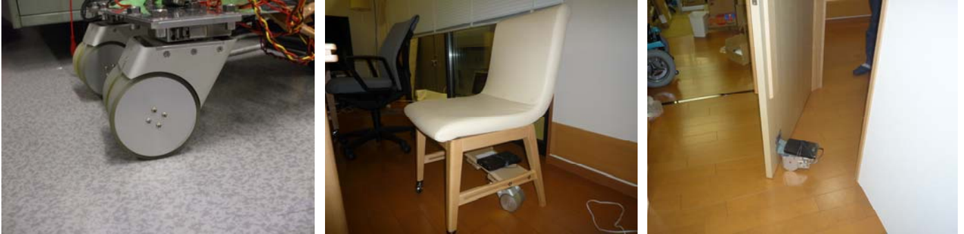
図8 アクティブキャスター外観（左）とアクティブキャスターを取り付けたイス（真ん中）およびドア（右）
