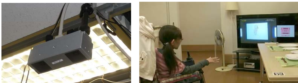
図7 ステレオカメラ（画像入力装置）（左）と手振りによる操作風景(右)
