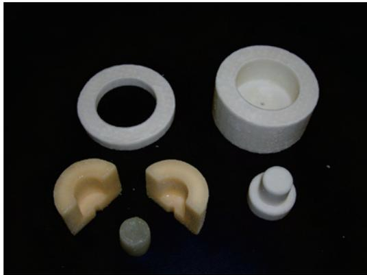
図 5 試作した電極充填用ゲル成型器（複数の部品からなる）および成形加工されたゲルチップ（最前列）
