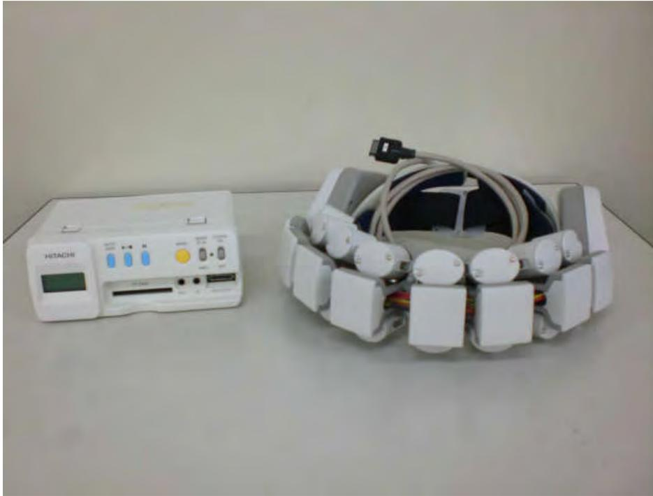
図 28 携帯型光トポグラフィ装置
