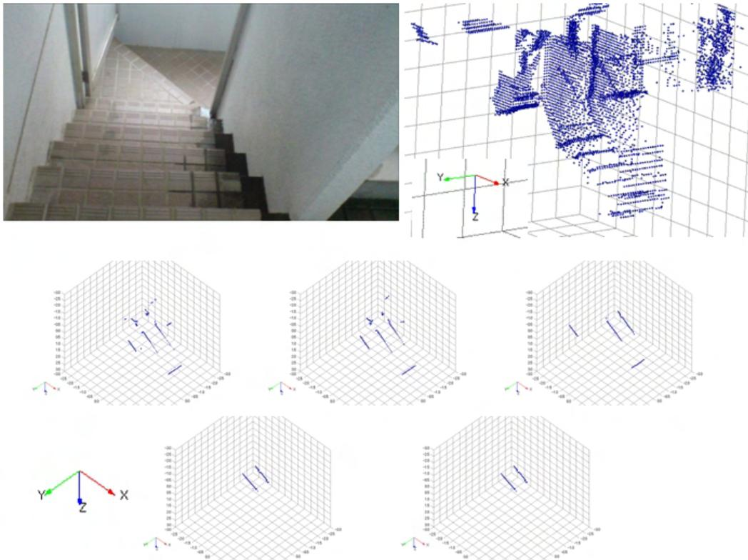
図 II.3-9 下り階段の場合の地形計測結果
