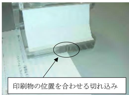
図一6 印刷物の端を合わせる切れ込み
