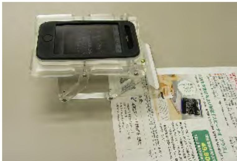
写真－1 SPコードを解析して読上げている例
