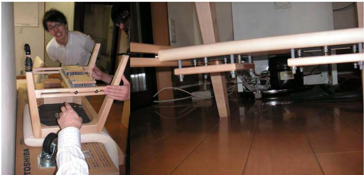
図II-6-34 イス下面のアクティブキャスター取り付け台座部分
