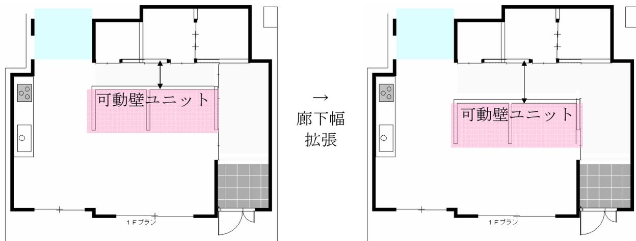
図II-6-13 可動壁ユニットの移動による廊下幅の変更
