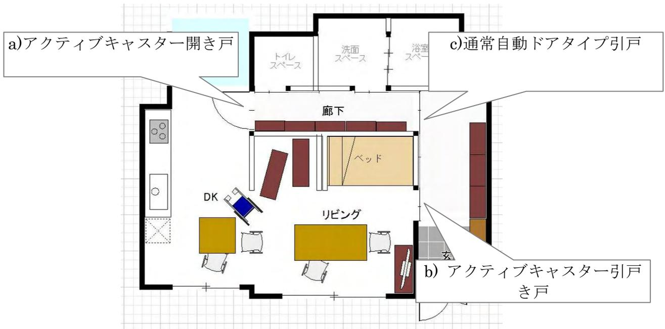
図II-6-37 自動開閉式内部建具の配置
