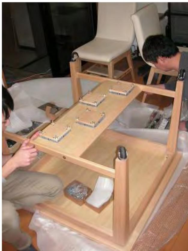
図II-6-31 テーブル下面のアクティブキャスター取り付け台座部分
