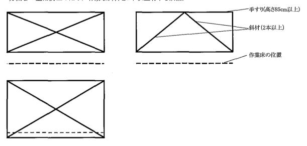
(3) 手すり及び労働者の墜落防止のために有効な鉛直材を2本以上有する設備 (作業床から高さ85センチメートル以上の位置に手すりがあり、かつ、作業床と手すりの間に 労働者の墜落防止のために有効な鉛直材を2本以上有する設備)
