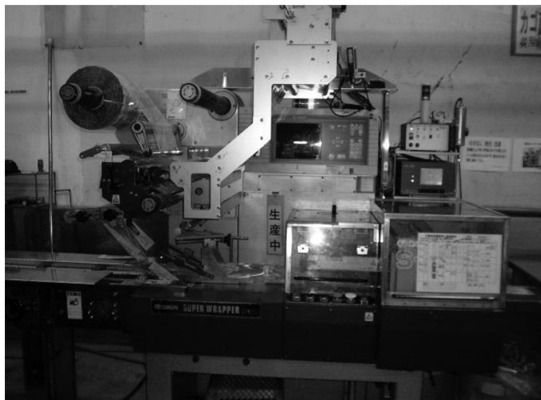
図1 はんぺん包装機改善例（改善前）
