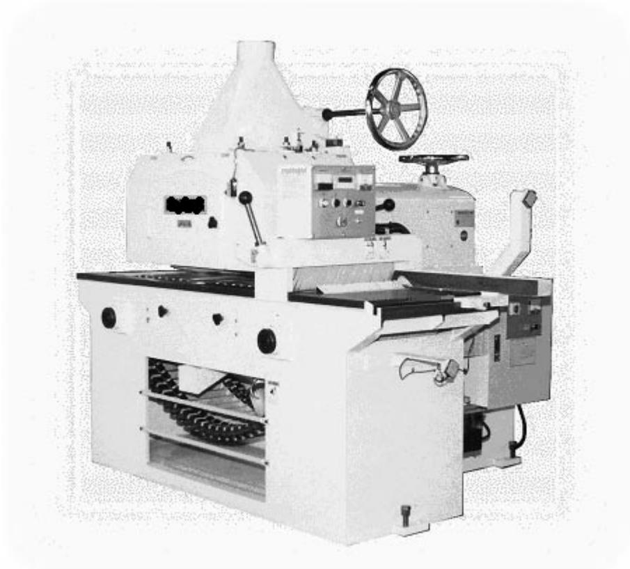
ギャングリップパとは幅広の原板を一度の送材で多数の小割材に挽き割る電動のこぎりで、刃部は以下のように複数の刃で構成され、当該刃部が交換できる用になっている。
