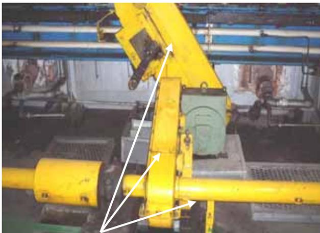
【ライン設備のローラー駆動用ドライブシャフト、及び駆動チェーンのカバー】
