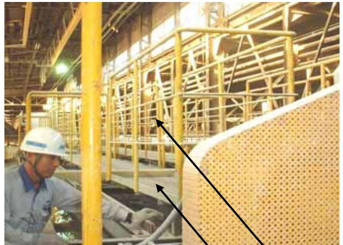
【タンク上部での清掃作業中のタンク内落下防止用歩廊と安全柵】
