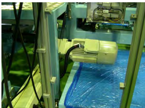
図 3-1 作業場への侵入部(1) モーターが突きだした、作業部 への侵入ステップ。
