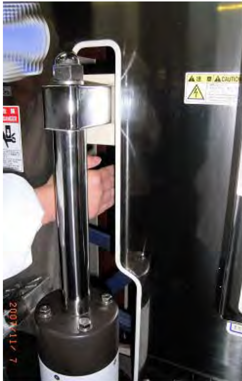
写真2 杵駆動部と本体との間の開口部
