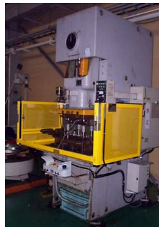
前面：ライトカーテン 侵入可能領域：固定ガードによる隔離
