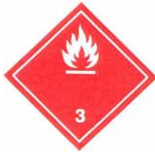
UN RTDG モデル規則の 引火性液体の絵表示 (シンボル：炎：黒または白、 背景：赤、下部の隅に数字の 3、最小寸法 100mm×100mm)
