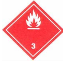
UN RTDG モデル規則の 引火性液体の絵表示 (シンボル：炎：黒または白、 背景：赤、下部の隅に数字の 3、最小寸法 100mm×100mm)
