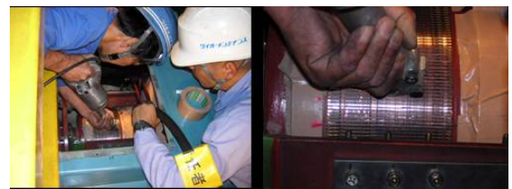
旋盤をカスタマイズして手で持てる大きさに改造して、小さな穴から旋盤の溝を削る。熟練だからこそなせる技である。
