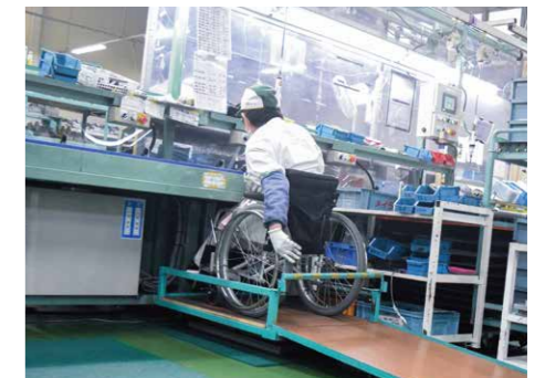
車いすを使用する人が作業しやすいよう設置された昇降台。
