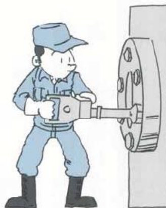
インパクトレンチによる作業
