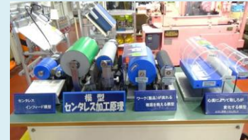
写真:センタレス加工原理の模型
