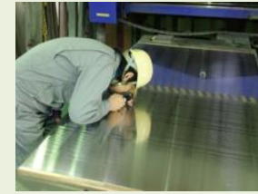
写真：連続鋳造用鋳型のめっき仕上がり状態の確認
