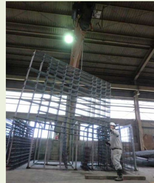
写真：天井クレーンで鉄筋を加工する機械へと運ぶ様子
