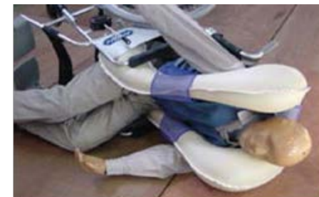
車椅子用転倒衝撃吸収装置 (欧米特許)
