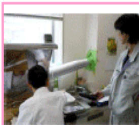
切出作業中の ホルムアルデヒド濃度測定
