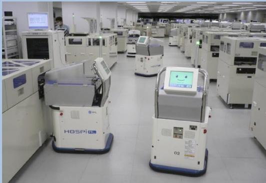
・ロボットの群制御や無軌道自律移動などを実用化し、複数台の自律移動ロボットが、生体臨床検査の搬送作業(※)を実施
