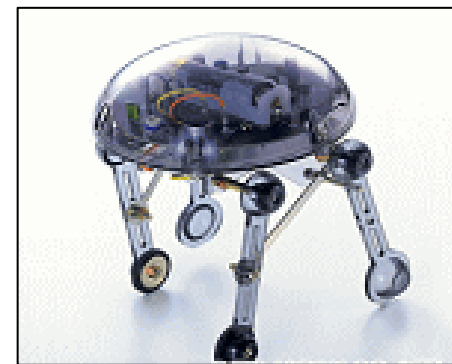
<ポリテックビジョン滋賀2008体験教室>様子音で動くセンサーロボットのはんだづけ組み立て完成品
